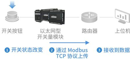
开关按钮 → 以太网型开关量模块 → 路由器 → 上位机
