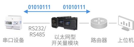
串口设备 ↔ (RS232/RS485) ↔ 以太网型开关量模块 ↔ 路由器 ↔ 上位机
