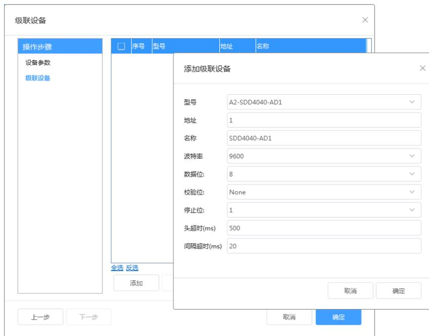
在级联设备中点“添加”在弹出的添加级联设备中完成级联设备的添加。
