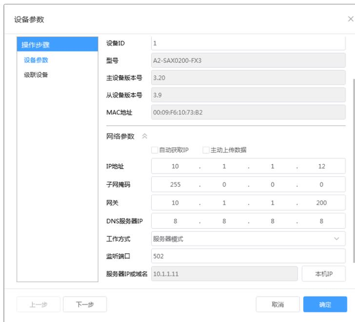
**自动获取IP**：如果勾选“自动获得 IP地址”，那么此IO设备所在网段当中的DHCP服务器将为其自动分配IP地址，但仍需**手动设置上本网段默认网关**，如不勾选“自动获得IP地址”需要手动为其指定IP地址和子网掩码、默认网关。
