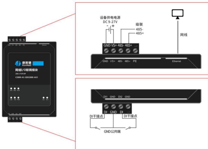
设备上电后，电源指示灯PWR红色常亮，运行指示灯RUN闪烁，设备供电正常。设备接上网线，网线另
