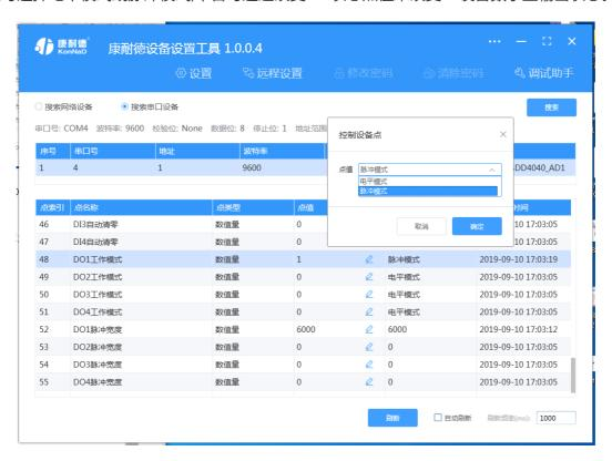
当DO为电平输出时,例如:如点击DO1状态点值后图标,写1时DO1指示灯点亮。写0时DO1指示灯熄灭。 当DO为脉冲输出时,可通过设置DO脉冲宽度来控制DO状态。例如:设置DO1脉冲宽度为6000,改变DO1点值 为1,则DO1灯点亮,6s后灯熄灭。
