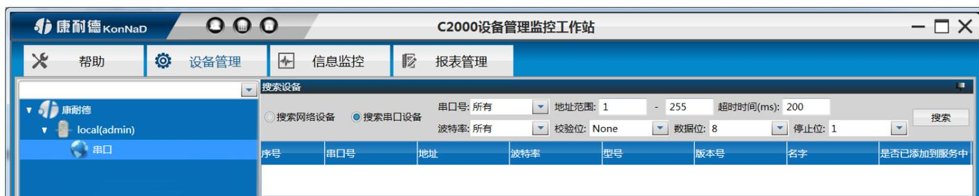
正确选择电脑连接C2000-S1-LS01L05-S01使用的串口，填入搜索的地址范围，在设置搜索范围时请根据实际情况进行设置，避免设置没有必要的大范围导致过长的搜索时间（**设备出厂的串口参数默认为9600、N、8、1**）。设置好搜索条件后点击“搜索”按钮，开始搜索，会找到连接在串口的设备。
